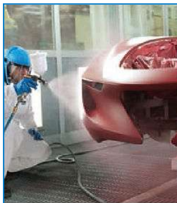
พ่นสีจริง Base Coat
