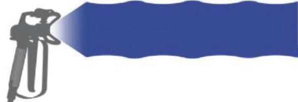
มานสีที่พ่นด้วยแรงดันต่ำออกมาจากเครื่องพ่นสีลูกสูบ Spray Jet at Low pressure from Piston Pump
