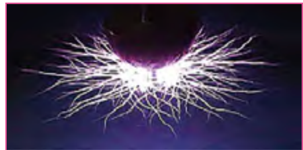
ภาพการเผยแพร่ไฟฟ้าสถิต (โดยศูนย์วิจัยทาคากิที่มหาวิทยาลัยอิวาเตะ) Propagating Brush Discharge
