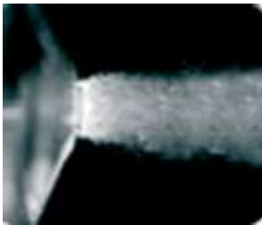
ม่านสีในระดับแรงดัน 3 บาร์ Spray Pattern with 3 bar pressure
