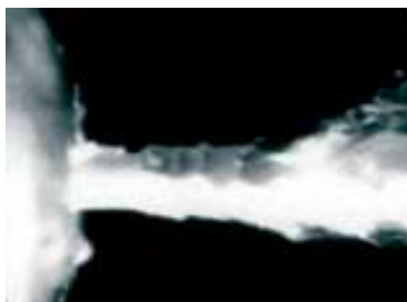
ม่านสีในระดับแรงดัน 3 บาร์ Spray Pattern with 3 bar pressure
