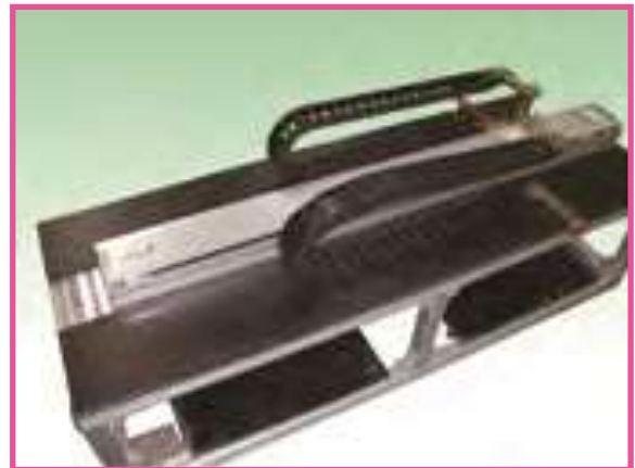
เครื่องทดสอบการหักโค้ง Slide Curvature Test Device
